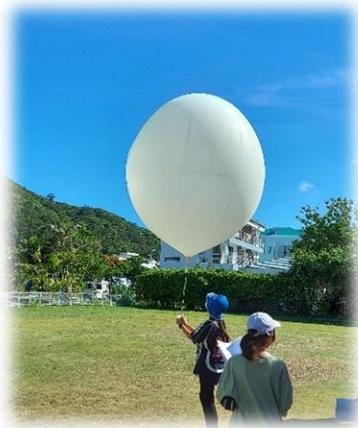
2日目に訪れた気象観測所では、ラジオゾンデの打ち上げに立ち会わせていただきました。写真のように、大きな風船の下に「ラジオゾンデ」という気象を観測できる装置を付け、上空に飛ばします。この観測は全世界で同時に行われており、1秒の誤差もないように施設の方々が協力して毎日行っているそうです。子供たちも風船を持たせていただきましたが、中身が水素ガスのため浮力が凄まじく、その強さにとても驚いていました。自分たちが普段目にしていない天気予報が、このような装置と観測所の方々のおかげで成り立っていることを、実体験を伴って学ぶことができました。
